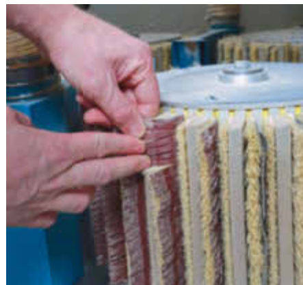
Die Schleifköpfe haben einen Ø von 400 mm. Für gleichmäßige Abnutzung oszillieren sie
