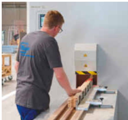
Alle Kanteln werden auf einer ROBA Fentech von MB Maschinenbau vorgeschliffen
