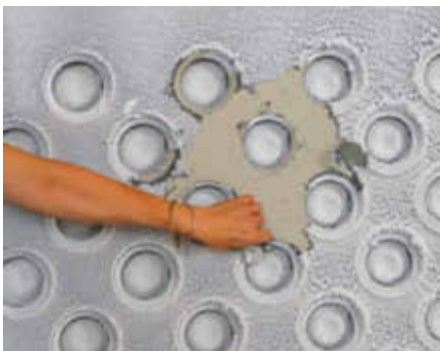
Ecola-Vorabscheider: Wasserlack haftet nicht auf PP und lässt sich leicht abziehen
