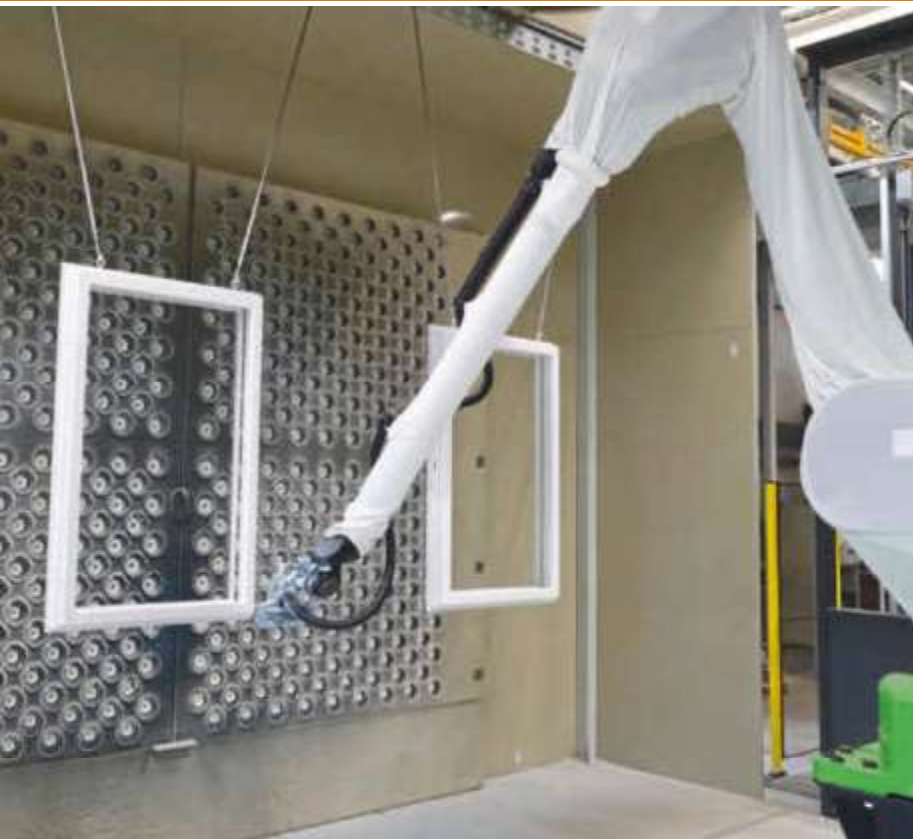
Materialsparend: Der von Range + Heine installierte CMA-Roboter ist mit der Zerstäubungsoptimierung Airmatic ausgestattet
