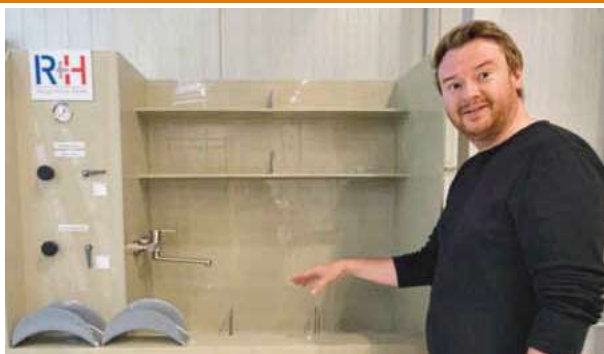
... und der Waschtisch zur Reinigung von lackberührten Komponenten wie Halterungen und Düsen
