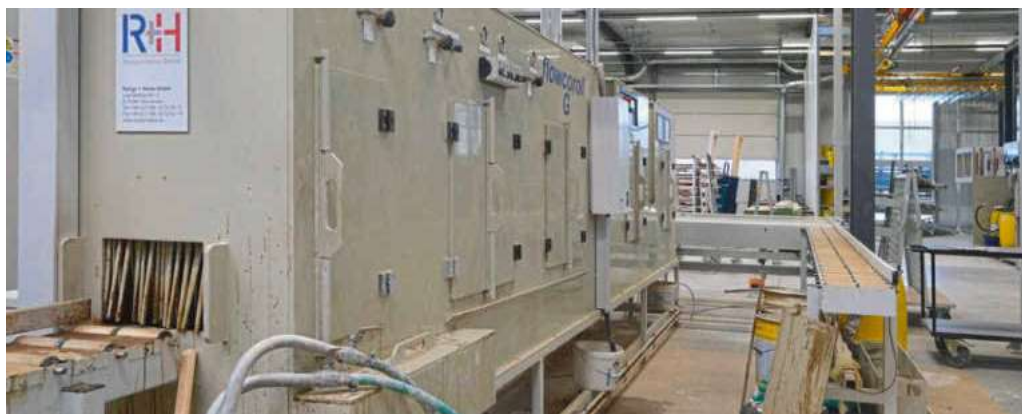
Mit Rückführung: Flutunnel Flowco-roll G für die horizontale Grundierung am Einzelteil
