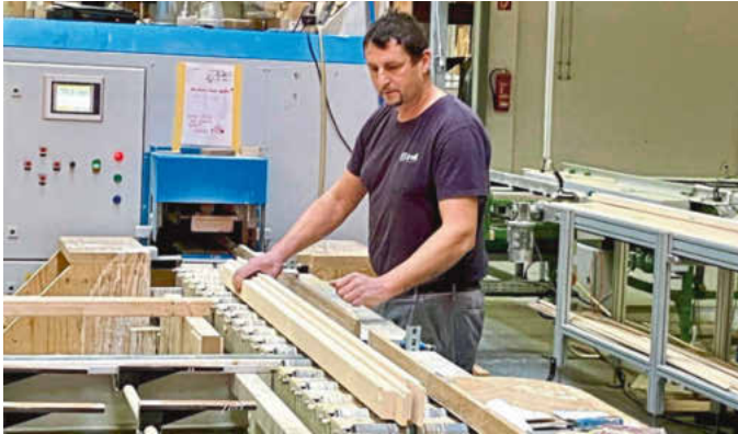
Die gesamte Bearbeitung findet am liegenden Einzelteil statt
