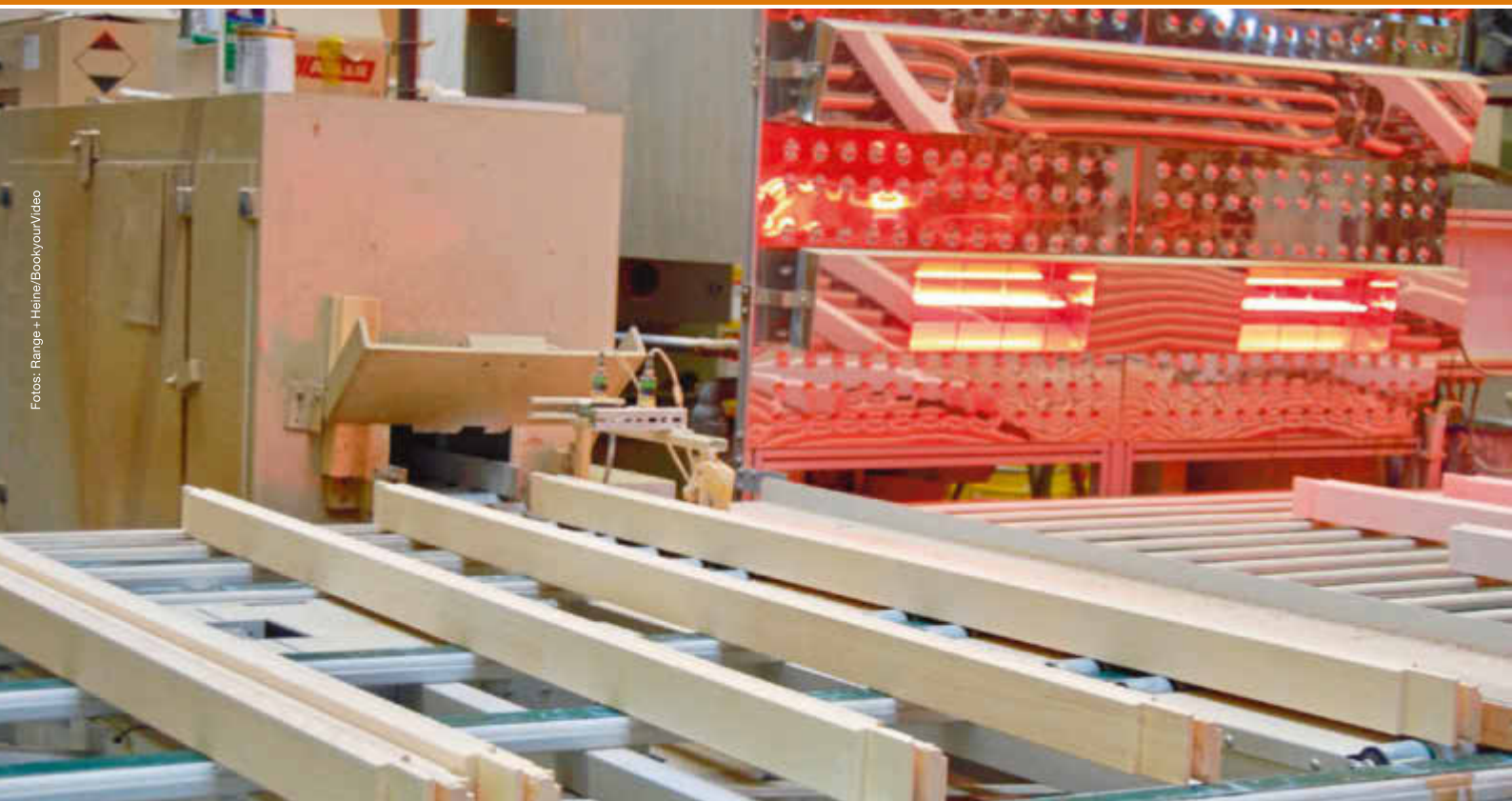
Fluten und Halogentrocknen am Einzelteil: So sehen bei Groß die ersten beiden Beschichtungsgänge aus
