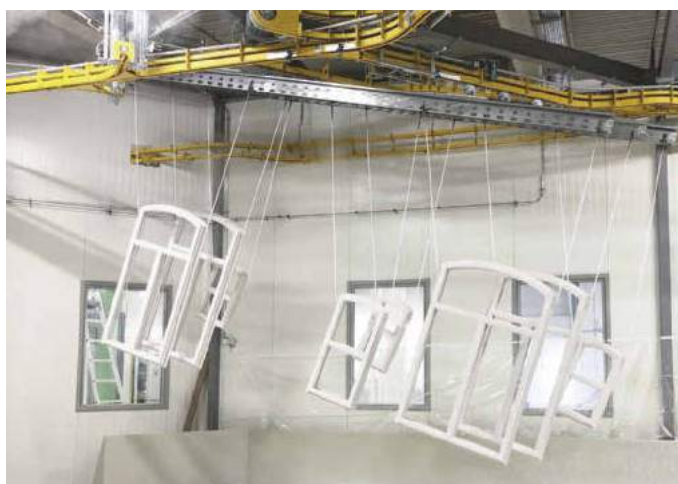
Die schräge Aufhängung nach dem Fluten sorgt für gutes Abtropfen
