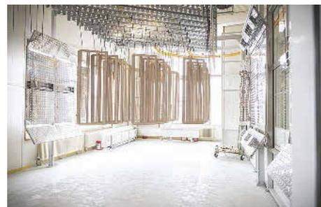
/ Die Fördertechnik mit 60 Traversen nimmt – je nach Größe der Elemente – bis zu 140 Fensterrahmen auf.
