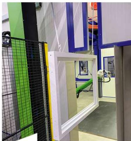
Die präzise 3D-Erkennung erfasst Lage, Profilstärke und auch die exakte Tiefe jedes einzelnen Bauteils und sorgt so für eine optimale und gleichbleibend hohe Beschichtungsqualität.
