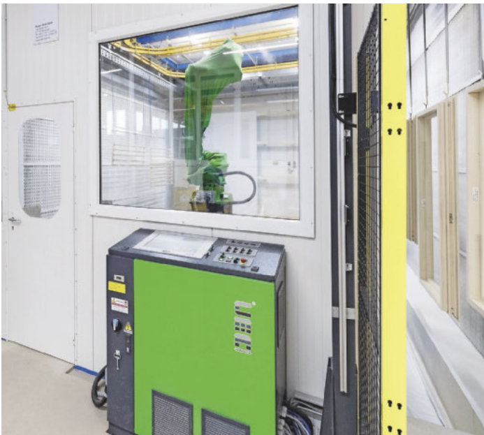
/ Eine 2D+-Scannerlösung mit Lackierroboter lohnt sich auch für kleinere Betriebe, wenn Fachkräfte fehlen.
