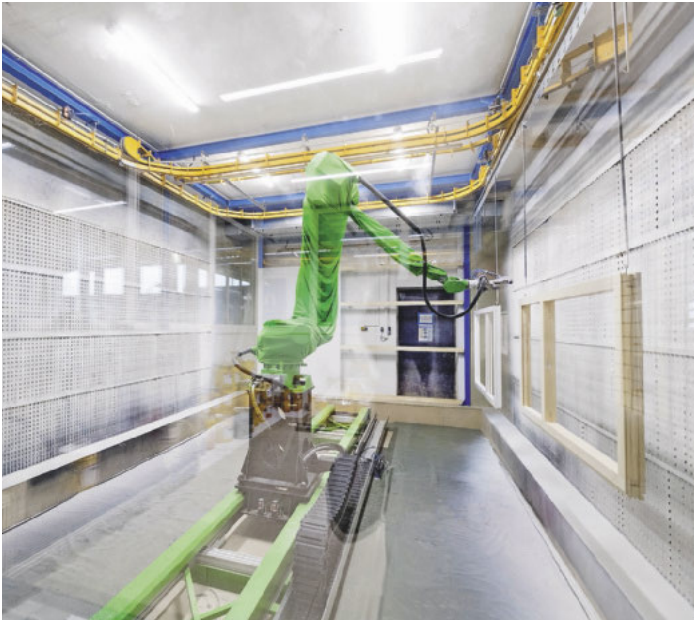
/ Über mehrere Verschiebebecken kann der Lackierroboter auch großen Werkstücken gerecht werden.
