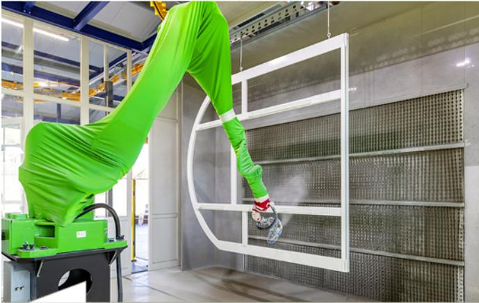
**Mit dem Spritzroboter können Fensterelemente in einer Größe von vier Metern Breite und drei Metern Höhe hergestellt werden.**
