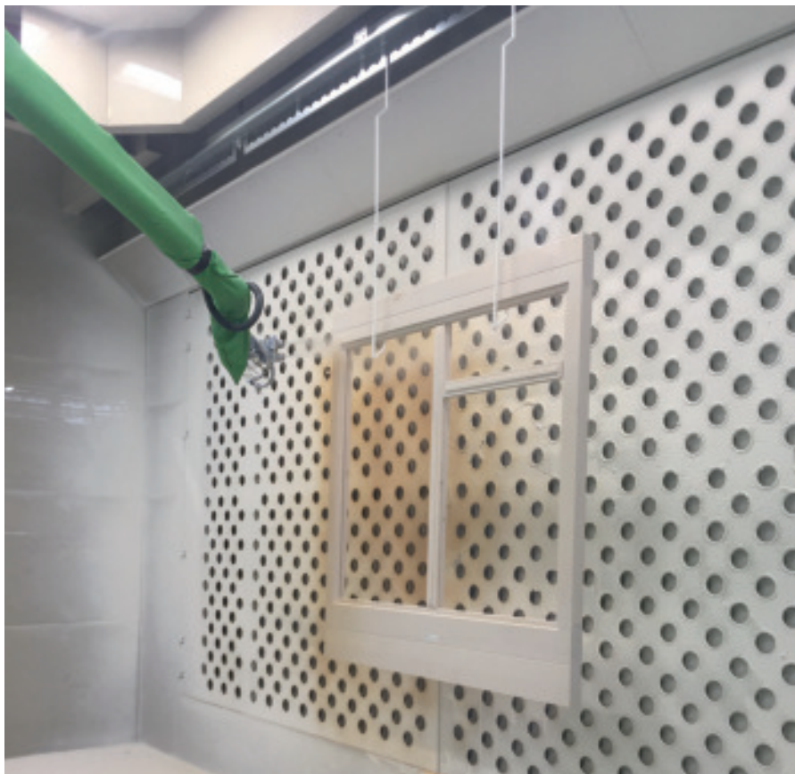
Die Abtropffläche ist mit Polypropylen verkleidet, das Material wird wieder in die Flutanlage zurückgeführt.
