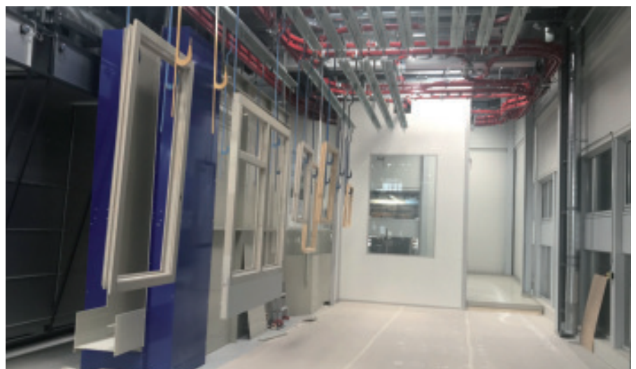
Die Teile hängen nicht immer ganz im Lot, wenn sie durch Scannerbereich und die Spritzkabine fahren. Dank 3D-Erkennung lackiert der Roboter stets parallel zur Oberfläche.
