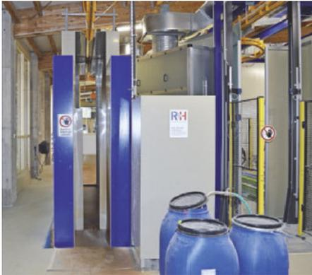
Für Grundierung/Imprägnierung: Flutanlage Flowcomat P+ von Range + Heine
