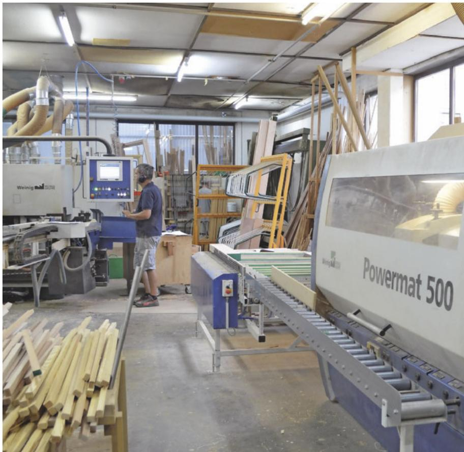
Friedrich fertigt seine Schlitz- und Zapfenverbindungen mit einer UC 6 von Weinig, gehobelt und profiliert wird mit einem Powermat 500
