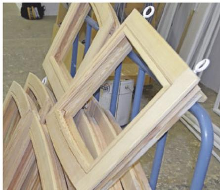
Oberflächenfertige Fenster mit eingesteckten Glasleisten und Aufhänge-Ösen
