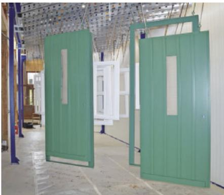
Trockenstrecke: Raumtemperatur mit Luftzirkulation und kontrollierter Luftfeuchte
