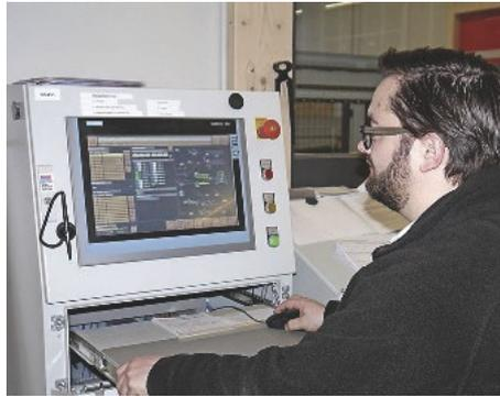
/ Kontrollzentrale: Vom Leitreechner aus lässt sich auf jedes Werkstück zugreifen, das derzeit unterwegs ist.
