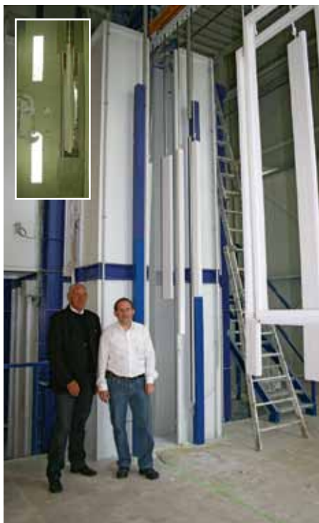
Werner Heine und Claus-Dieter Bauer (v. li.) vor der Lackieranlage, die Spritzpistolen stellen sich je nach Werkstück automatisch ein (kl. Bild)
