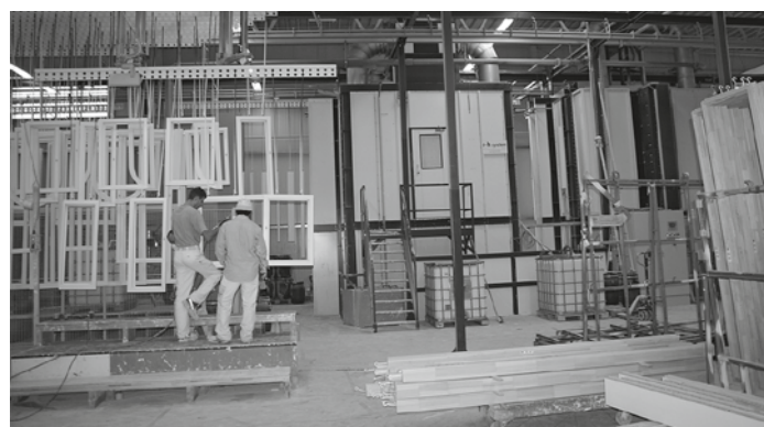
Automatische Lackieranlage von Range + Heine arbeitet in zwei Durchgängen – dazwischen werden die Fenster nochmals abgeschliffen (li.)
