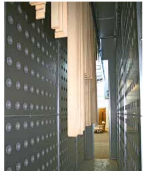
**Die grundierten Hölzer** benötigen im 6 m langen Hygrex-Kältetrockner lediglich 15 Minuten – in vergleichbaren Anlagen dauert es 30 Minuten
