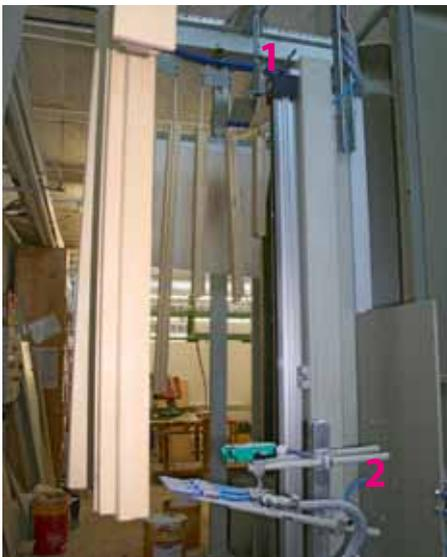
**Nach der Flutanlage** gelangen die Einzelteile zur Abblasstation von Range + Heine mit einer stationären (1) und mobilen (2) Luftdüse
