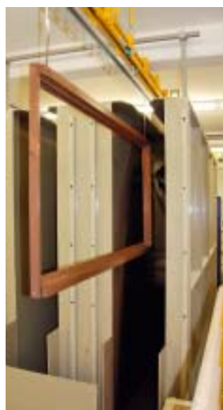
4 An den Auslauf der Flutstrecke schließt sich eine Abtropfzone an. Die Fensterelemente werden automatisch einseitig abgesenkt, damit das Grundiermaterial sauber ablaufen kann
