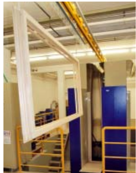
2 Ab in den Fluttunnel. Hin- und herschwenkende Stäbe bringen von beiden Seiten Material auf
