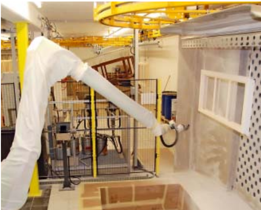
5 Die Endbeschichtung durch den Roboter: eine Seite lackieren, drehen, zweite Seite lackieren
