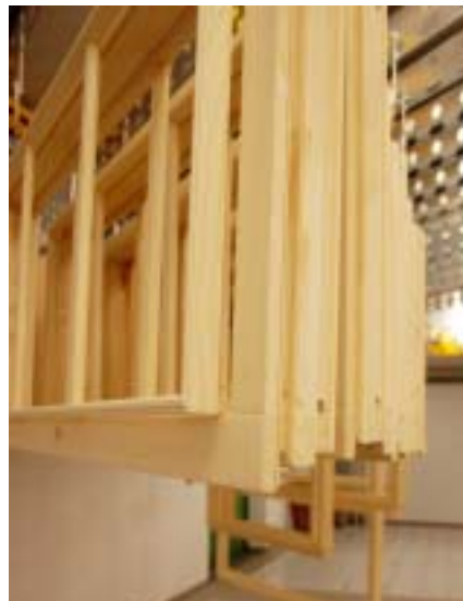
1 Fertig zum Fluten. Die Glasleisten sind zu Rahmen verbunden und am Flügel befestigt
