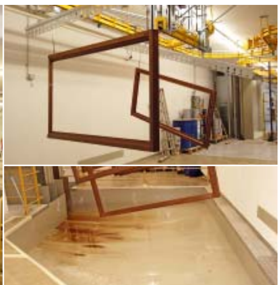
4 An den Auslauf der Flutstrecke schließt sich eine Abtropfzone an. Die Fensterelemente werden automatisch einseitig abgesenkt, damit das Grundiermaterial sauber ablaufen kann
