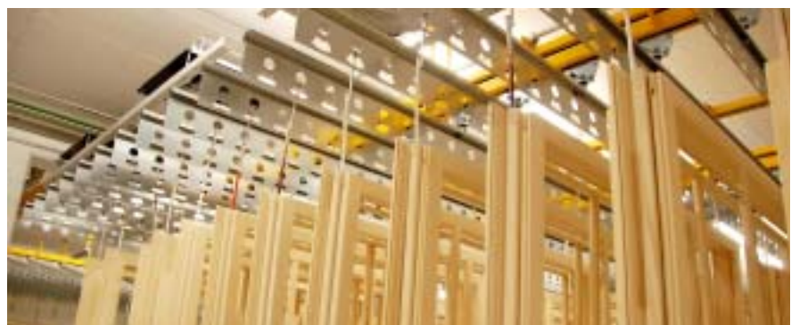
3 Trocknung: Deckenventilatoren beschleunigen den bei Raumtemperatur ablaufenden Prozess
