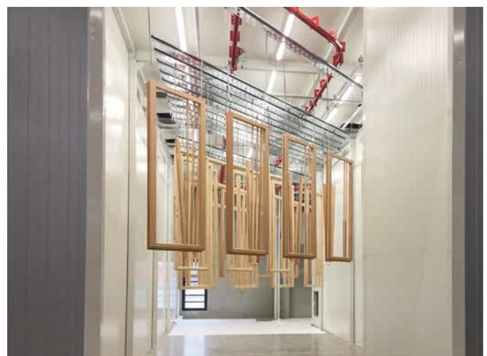
Spritzwand aktiv ist, an der gerade lackiert wird. Das verbessert die Absaugeffizienz, der Energieaufwand aber bleibt der gleiche wie bei einer einzelnen Absauganlage.
