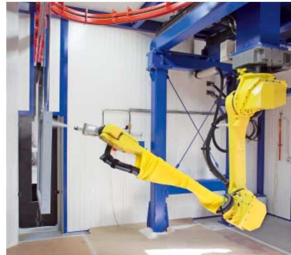
/ Die technische Ausstattung spiegelt den aktuellen Stand der Technik wider. Hier im Bild zu sehen ist der vollautomatische Sechssachs-Lackierroboter mit 3D-Teilerkennung aus dem Hause Reiter.
