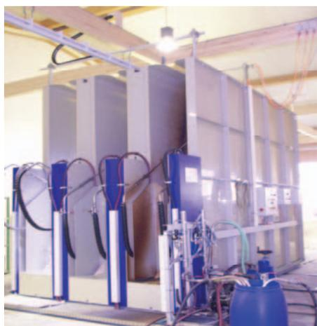
Das Flutzentrum wird eingesetzt für die Imprägnierung und Grundierung von Fenstern in lasierenden und deckenden Farbtönen. Es handelt sich um eine Kombination aus einer Range + Heine Anlage „flowcomat-M“ (molchbar) für den schnellen verlustarmen Farbwechsel und 2 Anlagen „flowcomat-P“ auf der Basis eines dynamischen Niederdruckflutverfahren. An den Flutbereich schließt sich eine forcierte Trocknungszone an.
