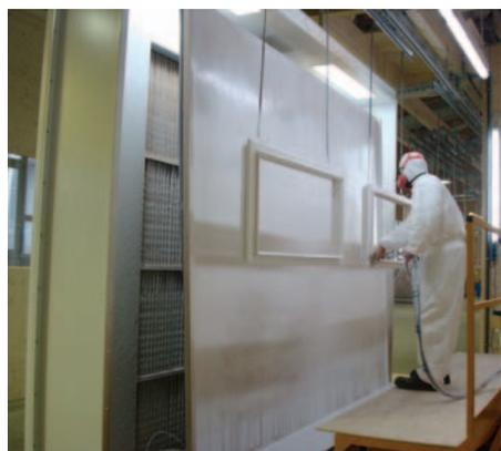
Einsatz einer Range + Heine Handspritzkabine mit integrierter „coolac®“ -Lackrückgewinnung mit dem Ergebnis einer hohen Lackeinsparung. Der Lackierer ist von allen ‚Handlingaufgaben‘ befreit, da die Werkstücke im Umlauf automatisch gewendet werden. Mittels eines Personenhebers wird für den Lackierer eine komfortable Lackierposition zur Anpassung an die Werkstückhöhe ermöglicht. Eine geregelte Umgebungsfeuchte ermöglicht beste Beschichtungsergebnisse.
