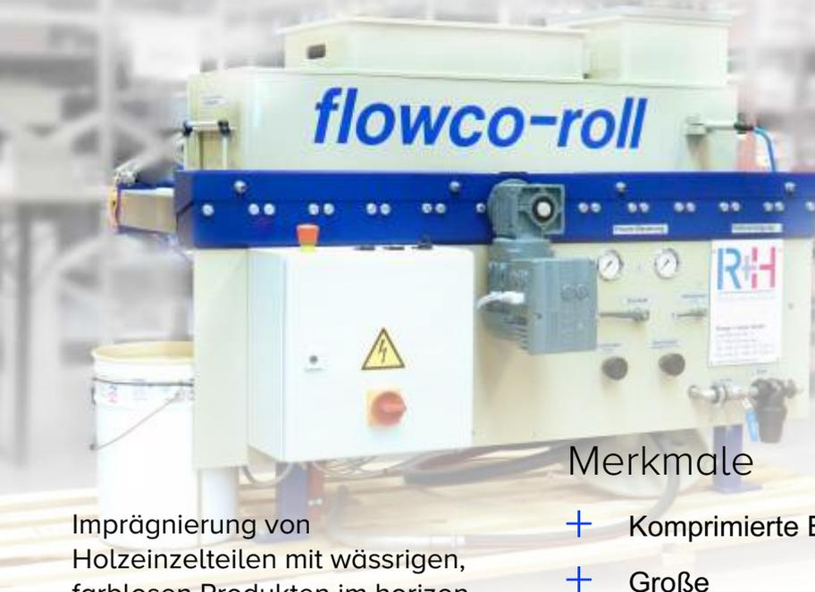
Imprägnierung von Holzeinzelteilen mit wässrigen, farblosen Produkten im horizontalen Niederdruck-Flutverfahren.
