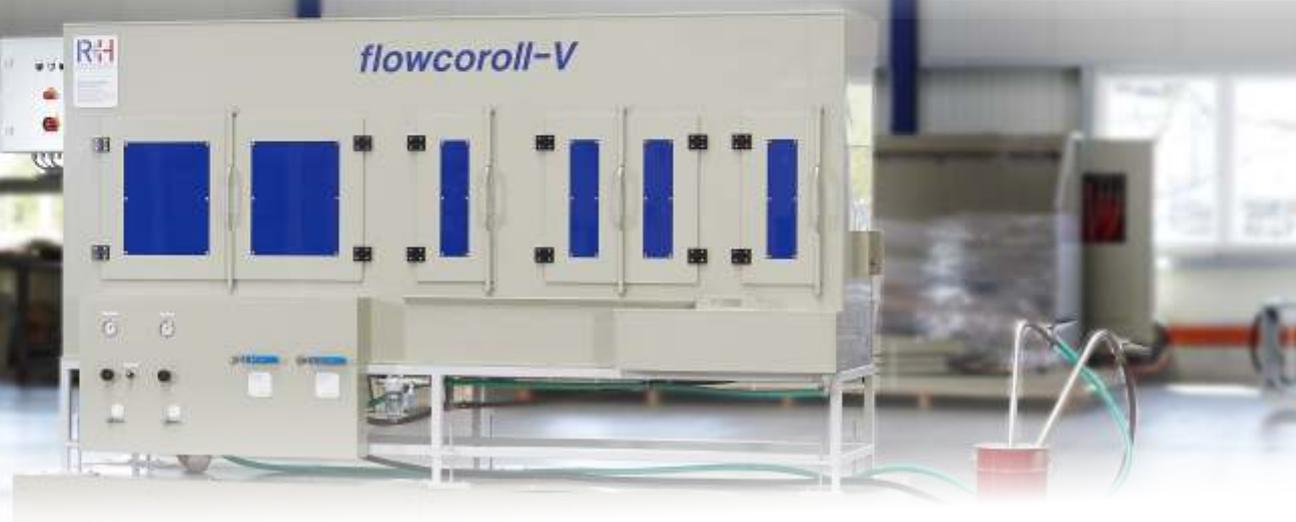
Die Imprägnieranlage flowcoroll V ist eine Variante der Standardanlage flowcoroll. Sie hat eine verstärkte Ablaseeinheit mit Hochdruckturbine, die unabhängig vom Druckluftnetz arbeitet. Die Trocknungszeit der Werkstücke wird verkürzt, sodass eine zügige Weiterverarbeitung der Teile möglich ist.
